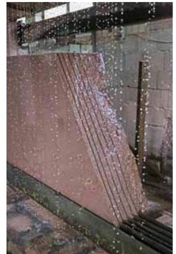
Oben: Wie im Sägewerk – die Gattersäge verwandelt einen Quader in Platten. Diamant-besetzte Sägeblätter machen es möglich
