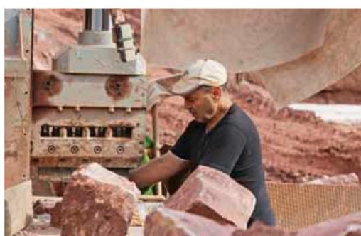
Nach der Sprengung (oben links und Mitte) gelangen die hochwertigen Sandsteinquader per Lkw in den Betrieb (unten links). Die Quader, aus denen sich keine Platten schneiden lassen, zerkleinern Mitarbeiter noch im Steinbruch mit hydraulischen Spaltern – etwa zu Mauer- oder Pflastersteinen (Mitte). Bildhauerin Anja Hartmann fertigt aus dem Sandstein allerlei Skulpturen (oben)
